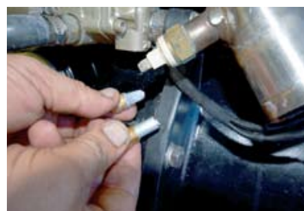
Lombardini Marine serija LMG 18000 ima dva cinka; jedan je na bloku motora, a drugi na samom alternatoru
