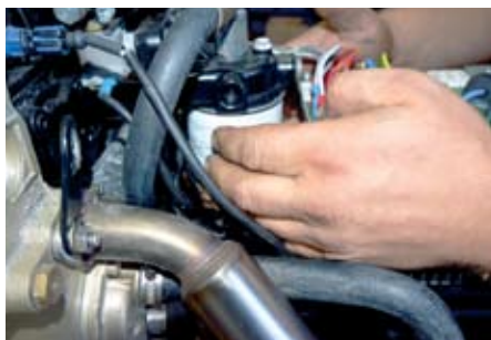
Nakon filtra ulja red je došao i na filter goriva
