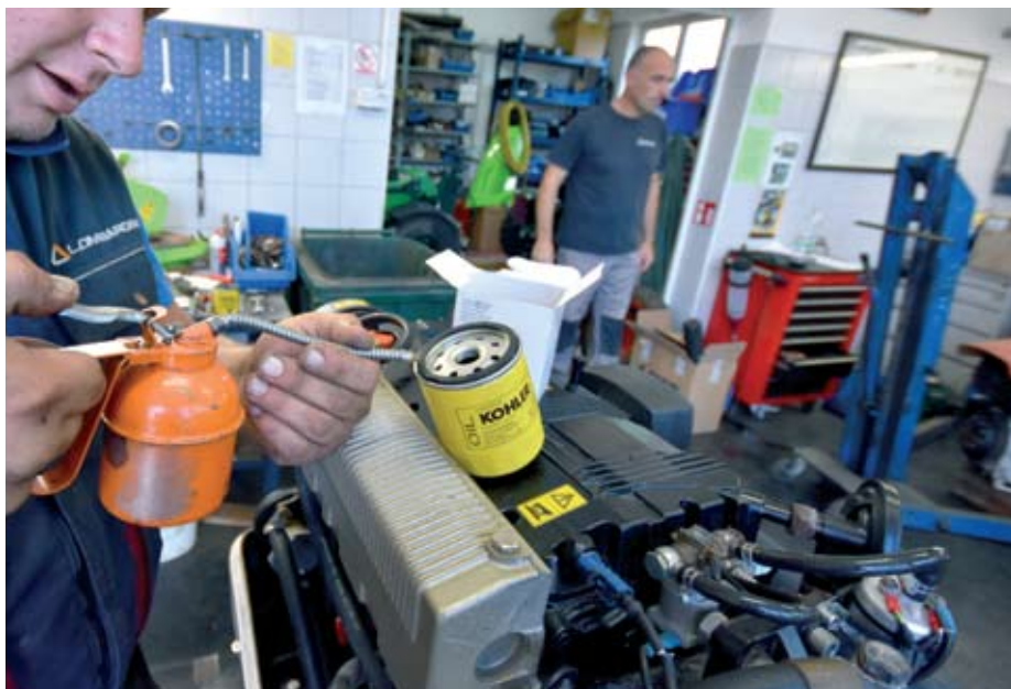
Pri stavljanju novoga filtra treba obratiti pozornost da se brtva prije postavljanja dobro podmaže jer u protivnom zapeče pa ju je pri sljedećem servisu vrlo teško skinuti
