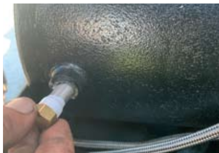
Lombardini Marine serija LMG 18000 ima dva cinka; jedan je na bloku motora, a drugi na samom alternatoru
