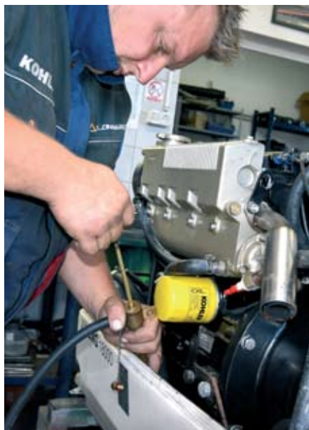
Ispumpavanje ulja teče vrlo jednostavno, a usis je postavljen u samom dnu kartera tako da je izvučeno svo staro ulje
