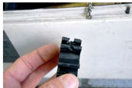
Impeler je bio jako oštećen prodorom naplavina, zato je zamijenjen novim
