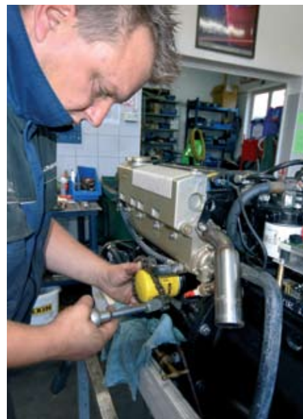
Kod izmjene ulja uvijek treba zamijeniti i filter
